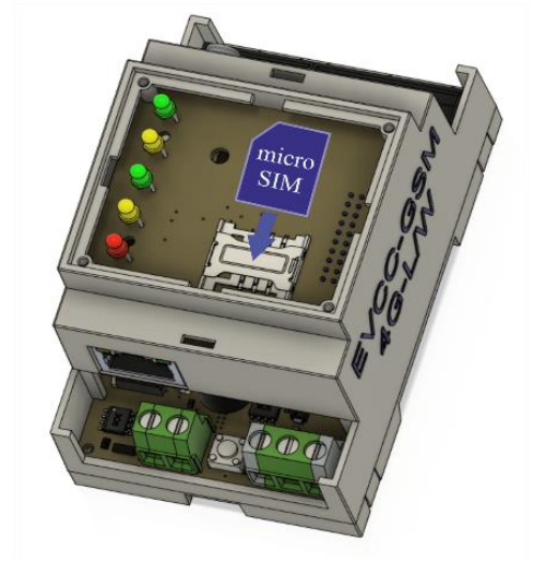
Рисунок 5.21. Installing a SIM-card into the GSM-module
