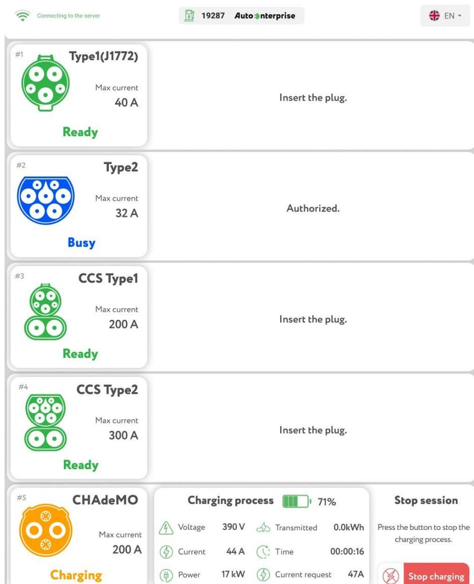
Рисунок 6.2 Відображення процесу зарядки на екрані станції
