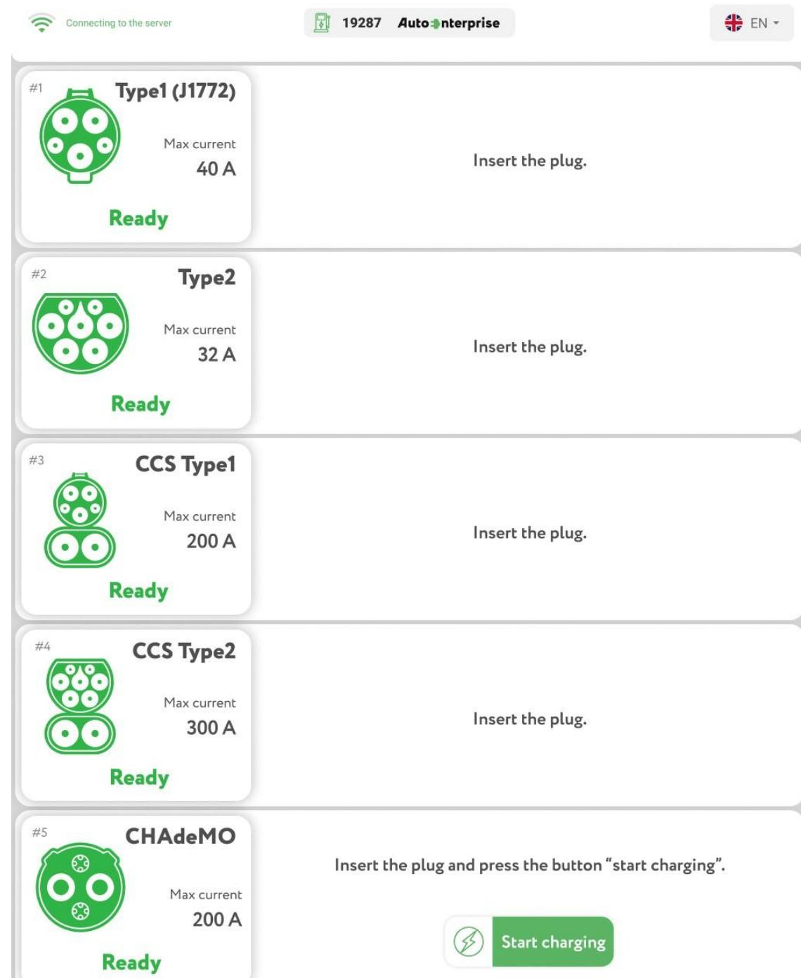
Рисунок 6.1 Екранне відображення готової до роботи станції
