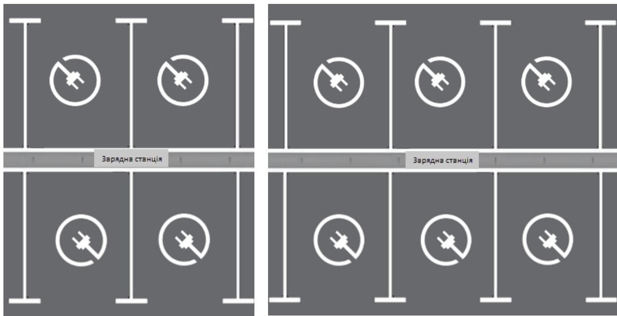
Рисунок 5.2. Розташування станції на 4 та 6 паркувальних місць відповідно
