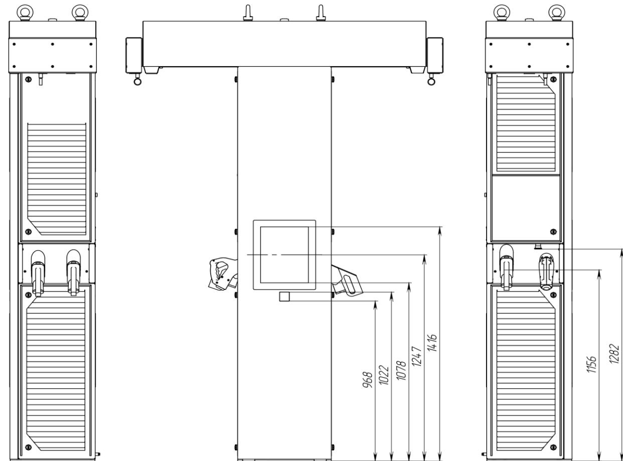
Рисунок 4.2. Висота функціональних частин станції.
