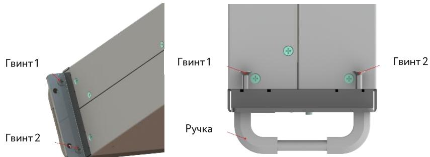
Рисунок 5.11. Розташування кріплень
