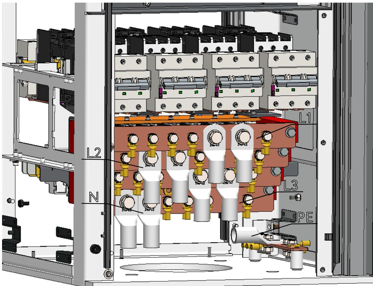
не менше 25 мм<sup>2</sup>, з використанням болтового з'єднання М10 з маркуванням «РЕ», розташованим в клемній камері.
