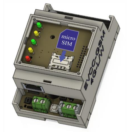
Рисунок 5.21. Установка SIM-карти в GSM-модуль
